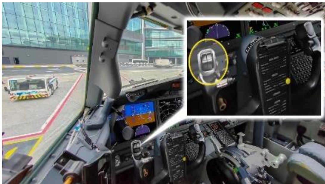
Кнопки управления электроприводом стабилизатора на штурвале
