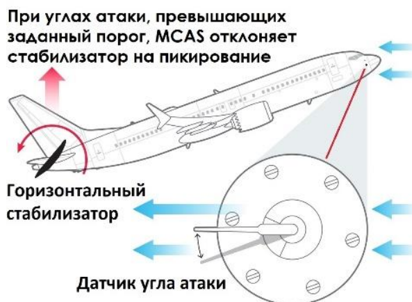
Принцип работы системы MCAS на 737 MAX
