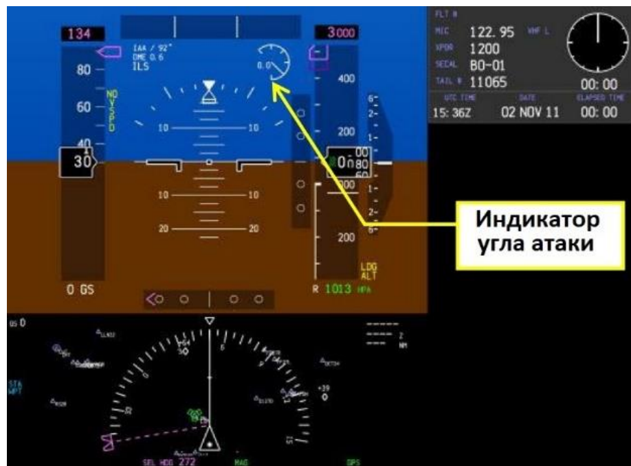
Оptionальный индикатор угла атаки на основном пилотажном дисплее 737 MAX
