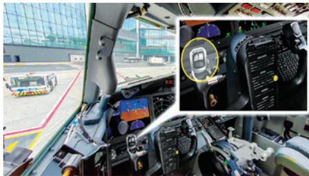
**Кнопки управления электроприводом стабилизатора на штурвале**
