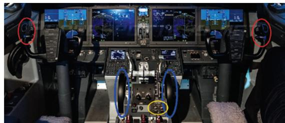
**Кабина 737 MAX. Синим обведены барабаны ручного управления стабилизатором, красным – кнопки управления электроприводом стабилизатора на штурвалах, жёлтым – выключатели электропривода стабилизатора**
