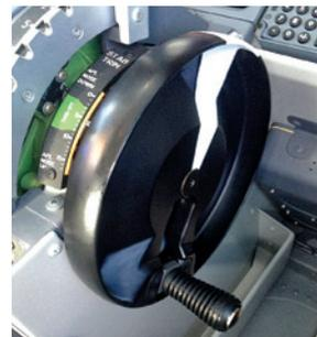
**Барабан для ручного управления стабилизатором**
