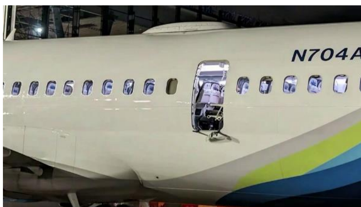
Boeing 737 MAX 9, рейс 1282, без панели-заглушки
