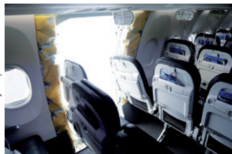
Фюзеляж Boeing 737 MAX 9, рейс 1282, без панели-заглушки
